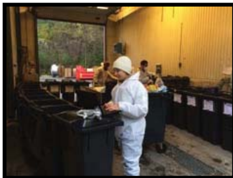
Bilde 5 Innveiing og registrering av vekt på beholdere for de ulike avfallsfraksjonene (25 kategorier)
