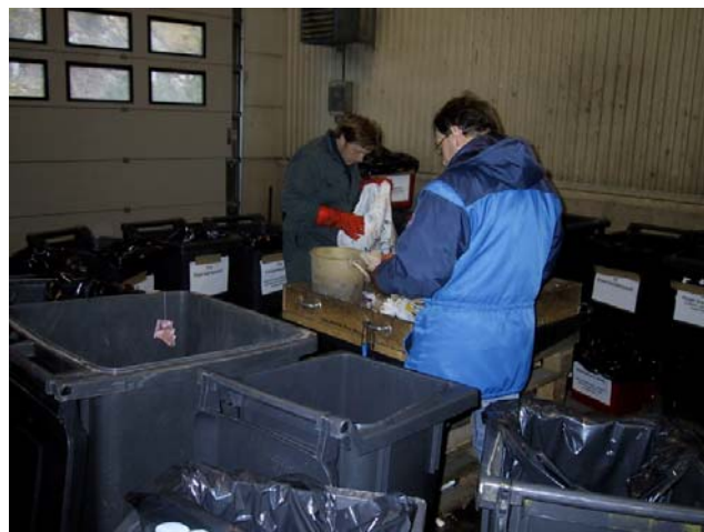
Bilde 6: Beholdere ble stilt opp i ring rundt sorteringsristen.. Hver person hadde spesielt ansvar for "sine" fraksjoner. Som regel stod det 1 person på hver av de 4 siden på sorteringsristen.
