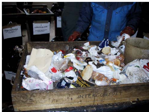
Bilde 8: Avfallet ble lagt på en sorteringsrist og de forskjellige avfallsfraksjonene ble tatt ut og lagt i beholdere merket med nummer og navn på fraksjon.
