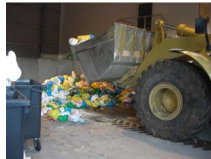
Bilde 6: Uttak av prøve til sortering fra prøveområde. I tillegg ble noe avfall tatt ut manuelt
